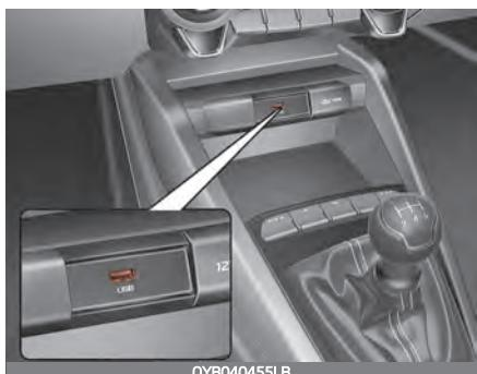
Порт USB можно использовать для подключения устройств USB.
