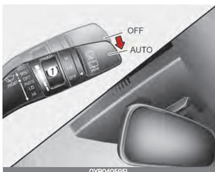
Датчик дождя, расположенный на верхней части лобового стекла, определяет количество осадков и регулирует интервал цикла очистки стекла. Чем сильнее становится дождь, тем быстрее работает стеклоочиститель. Когда дождь прекращается, стеклоочиститель останавливается.
