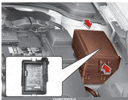
Панель с предохранителями в моторном отсеке
