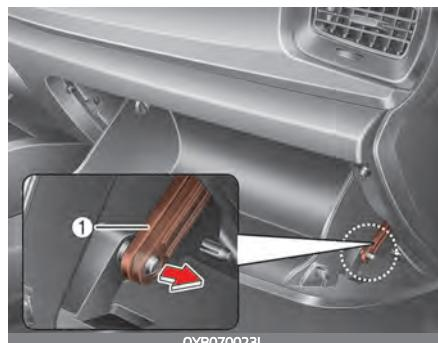
3. Снимите крышку воздушного фильтра климат-контроля, одновременно нажав на замок с правой стороны крышки.
