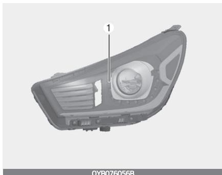
Если лампа габаритных и дневных ходовых огней (светодиодные) (1) не работает, следует проверить автомобиль в специализированной мастерской.
