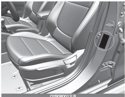
На сертификационной табличке автомобиля (которая находится на средней стойке со стороны водителя или пассажира) имеется идентификационный номер автомобиля (VIN).
