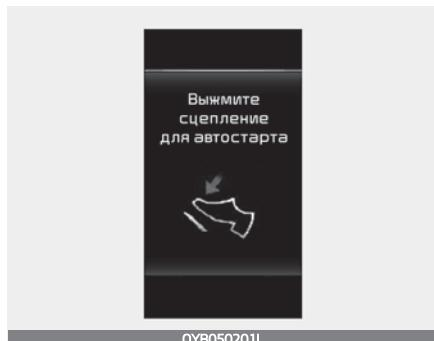
Если непреднамеренно выключить двигатель во время движения автомобиля при включенной передаче и не выжатой педали сцепления, система отобразит показанное ниже предупреждающее сообщение. Если на этом этапе водитель полностью выжмет педаль сцепления, двигатель повторно запустится автоматически. (Только при наличии системы ISG с функцией Late Restart, за исключением автомобилей 48V HEV)
