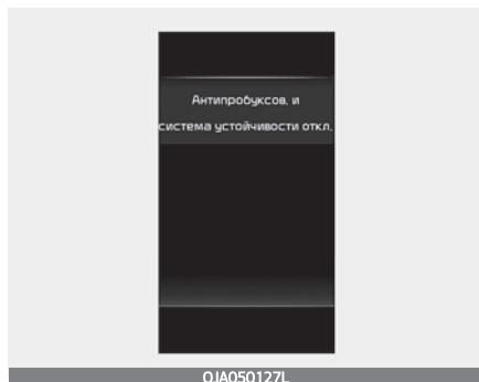
Нажмите кнопку «ESC OFF» (ВЫКЛ. ESC) более чем на 3 секунды. Загорится индикатор «ESC OFF» (ESC ВЫКЛ.) и прозвучит предупредительный сигнал «ESC OFF». В этом состоянии функции управления двигателем и управления тормозами отключаются. Это означает, что система курсовой устойчивости автомобиля также отключается.
