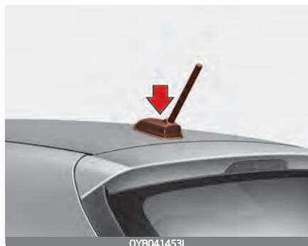
Микромачтовая антенна на крыше передает и принимает беспроводные сигналы, например AM/FM, DAB, GNSS и т. д.
