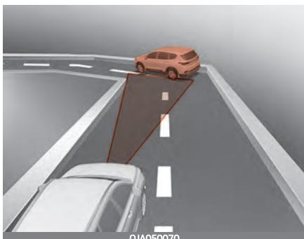
Скорость автомобиля, может быть снижена с учетом транспортного средства в соседней полосе движения.
