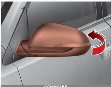
Для того чтобы сложить наружное зеркало заднего вида, возьмитесь за корпус зеркала и сложите его по направлению к задней части автомобиля.
