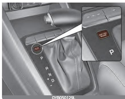
Если рычаг переключения передач невозможно переместить из положения «P» (парковка) или «N» (нейтраль) в положение «R» (задний ход) при нажатой педали тормоза, продолжайте нажимать на тормоз, а затем выполните следующие действия.
