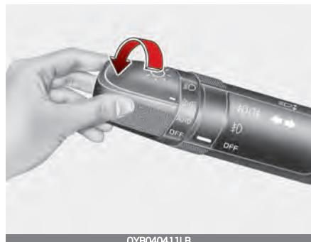
Когда переключатель освещения находится в положении работы стояночных огней (вторая позиция), то работают задние габаритные огни, фонарь освещения номерного знака и подсветка приборной панели.
