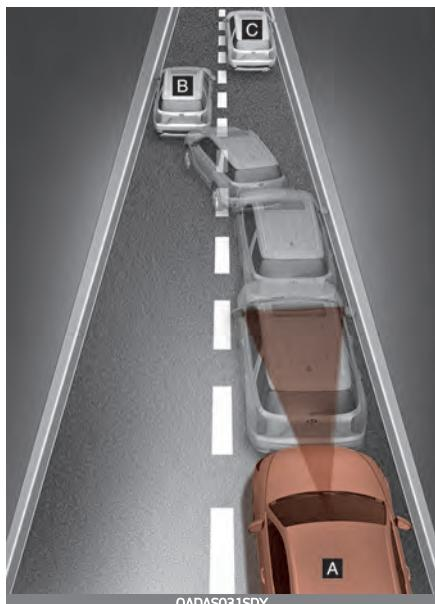
«А»: ваш автомобиль, «В»: автомобиль, перемещающийся на другую полосу, «С»: автомобиль на вашей полосе
