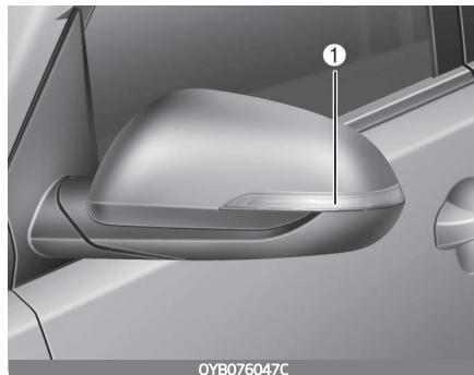
Если боковой повторитель указателя поворота (светодиодный) (1) не работает, следует проверить автомобиль в специализированной мастерской.
