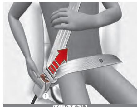
Чтобы отстегнуть ремень безопасности, нажмите кнопку разблокировки (1) на пряжке. После отстегивания ремень должен автоматически возвращаться в натяжитель.
