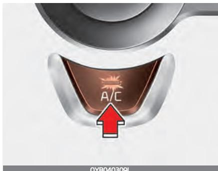
Нажмите кнопку «A/C» (Кондиционер), чтобы включить систему кондиционирования (загорится индикаторная лампа). Для того чтобы выключить систему кондиционирования, нажмите эту кнопку еще раз.
