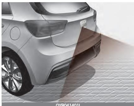
Монитор заднего вида активируется при работающем двигателе, если рычаг переключения передач находится в положении «R» (задний ход).
