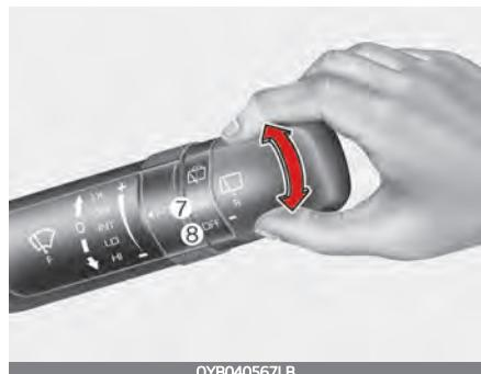
Переключатель стеклоочистителя и стеклоомывателя заднего стекла расположен на конце рычага с переключателем стеклоочистителя и стеклоомывателя. Поверните переключатель в требуемое положение для работы заднего стеклоочистителя и стеклоомывателя.
