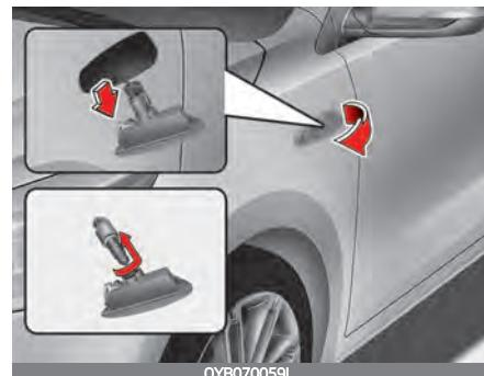
1. Извлеките узел лампы из автомобиля поддев рассеиватель и вытащив узел.
