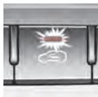
При выборе положения рециркуляции воздух из салона подается в систему отопления и нагревается или охлаждается в зависимости от выбранной функции.
