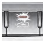
При выборе положения рециркуляции воздух из салона подается в систему отопления и нагревается или охлаждается в зависимости от выбранной функции.
