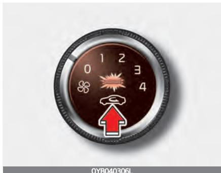
С помощью регулятора забора свежего воздуха можно выбрать забор наружного (свежего) воздуха или режима рециркуляции.
