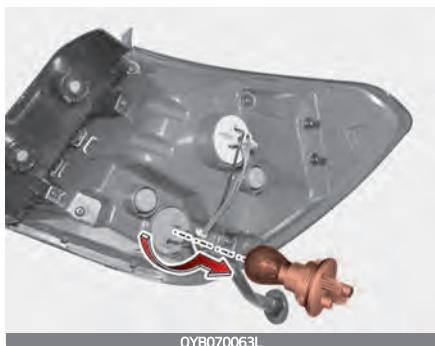
8. Установите патрон на место, совместив выступы на патроне с прорезями на узле. Вставьте патрон в узел, после чего поверните патрон по часовой стрелке.
