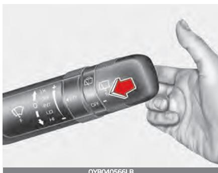
В выключенном положении (O) (Выкл) слегка потяните рычаг на себя, чтобы разбрзгать омывающую жидкость на лобовом стекле и запустить 1–3 цикла стеклоочистителей.
