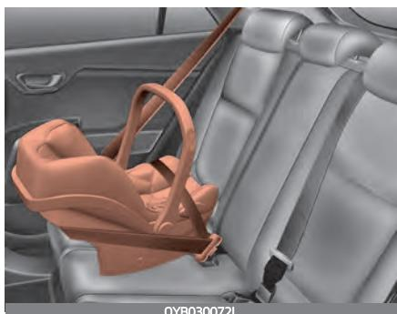
Детская удерживающая система с расположением против хода движения обеспечивает удерживание с помощью поверхности, на которую опирается спина ребенка. Система ремней удерживает ребенка на месте, а во время дорожно-транспортного происшествия удерживает его в детской удерживающей системе, снижая нагрузку на хрупкую шею и позвоночник.
