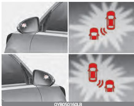
Чтобы предупредить водителя о приближающемся транспортном средстве сзади с левой/правой стороны, индикатор на наружном зеркале заднего вида будет мигать, а на приборной панели появится предупреждение. Одновременно звучит звуковое предупреждение, и рулевое колесо начнет вибрировать. Если включена камера заднего вида, на экране информационно-развлекательной системы появится предупреждение.
