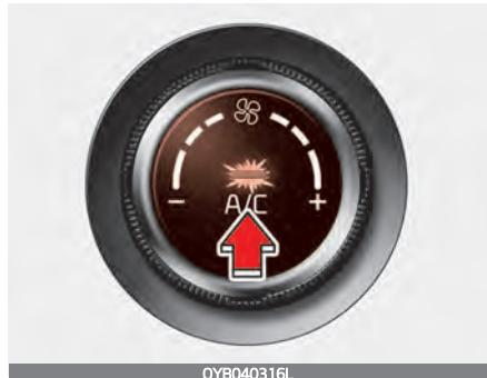
Нажмите кнопку «A/C» (Кондиционер), чтобы включить систему кондиционирования (загорится индикаторная лампа).
