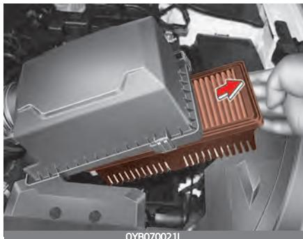
4. Зафиксируйте крышку с помощью фиксаторов.
