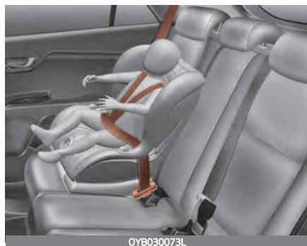
Детское автокресло с ориентацией по ходу движения обеспечивает фиксацию ребенка при помощи ремней. Перевозить ребенка в детском автокресле с ориентацией по ходу движения, снабженном ремнями, следует до тех пор, пока рост и вес ребенка не достигли ограничений, установленных производителем детского автокресла.
