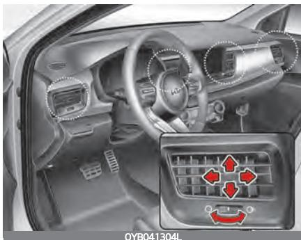
Дефлекторы можно открыть или закрыть по отдельности с помощью дискового переключателя. Чтобы перекрыть вентиляционное отверстие, поверните его вниз до упора.
