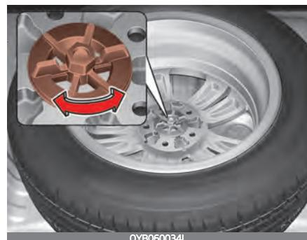
Поверните болт крепления шины против часовой стрелки.
