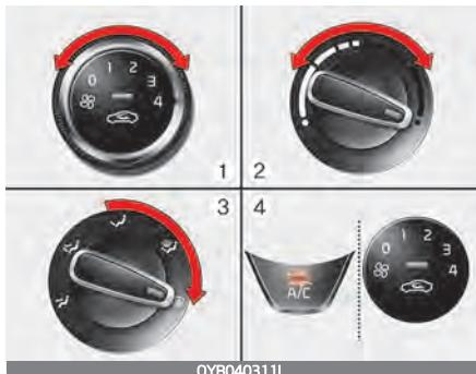
Если режим кондиционирования и забора свежего (наружного) воздуха не выбран автоматически, нажмите на соответствующую кнопку вручную.
