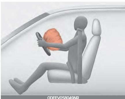
Когда срабатывают подушки безопасности, под давлением от их развертывания отделяются отрывные швы в предохранительных крышках. После открывания крышки подушка безопасности полностью надувается.
