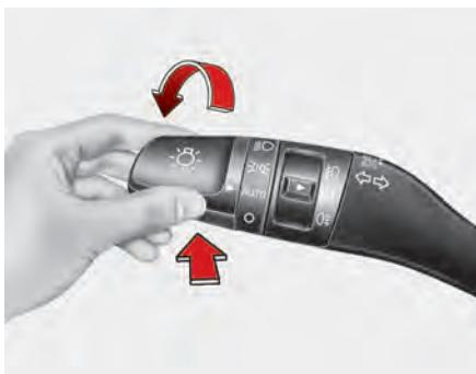
Функция автоматического переключения фар дальнего света — это система, которая автоматически регулирует дальность света фар (переключает режимы ближнего и дальнего света фар) в зависимости от яркости света от других автомобилей и дорожных условий.
