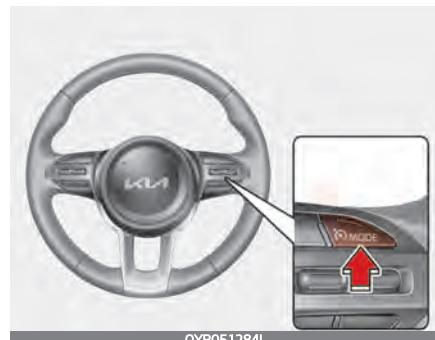
Для отключения системы круиз-контроля нажмите кнопку «Driving Assist» (Режим помощи при управлении автомобилем). Индикатор «Cruise» (CRUISE) (Круиз-контроль) погаснет.
