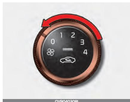
Для того чтобы выключить нагнетающие вентиляторы, поверните регулятор скорости вентилятора в положение «0».
