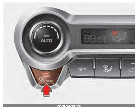
При выборе режима обогрева стекла автоматически устанавливаются следующие настройки:
