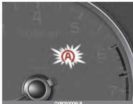
Для индикации работы системы ISG используется лампа на приборной панели. Если автомобиль оснащен приборной панелью, на ЖК-дисплее отобразится примечание.
