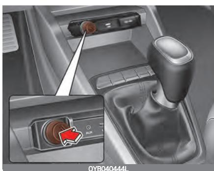
Для использования прикуривателя ключ зажигания должен находиться в положении «ACC» или «ON».
