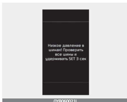
При наличии полуспущененной шины загорается сигнальная лампа (W). Вышеуказанное сообщение может отображаться на комбинации приборов определенного типа.
