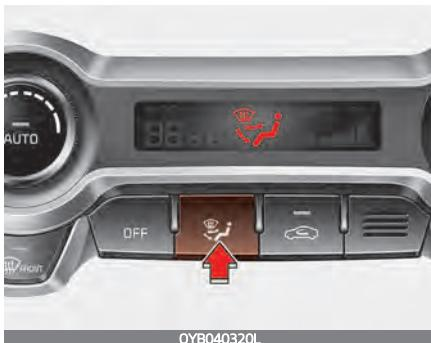
Кнопка выбора режима управляет направлением потока воздуха через вентиляционную систему.
