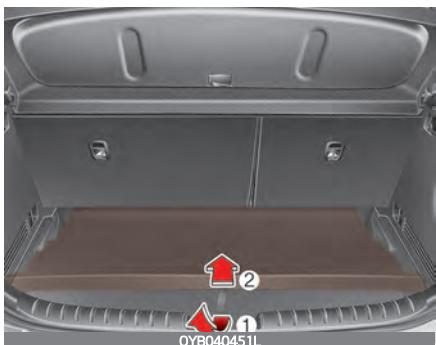
3. Потяните полку багажника таким образом, чтобы шарниры достигли концов пазов. Полка откинется вниз, освободив дополнительное место для багажа.
