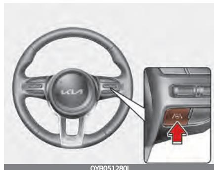
Чтобы включить систему контроля полосы движения, переключите кнопку «ENGINE START/STOP» (запуска/остановки двигателя) в положение «ON» (Вкл.) и нажмите расположенную на рулевом колесе кнопку системы удержания полосы движения.
