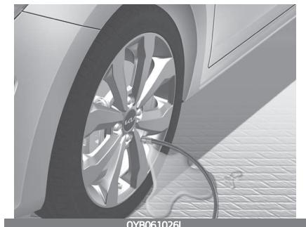
Надежно подсоедините шланг для заливки герметика к клапану. В противном
