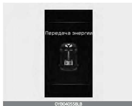
Для питания используется энергия привода и двигателя. (Аккумулятор и двигатель → Колесо)
