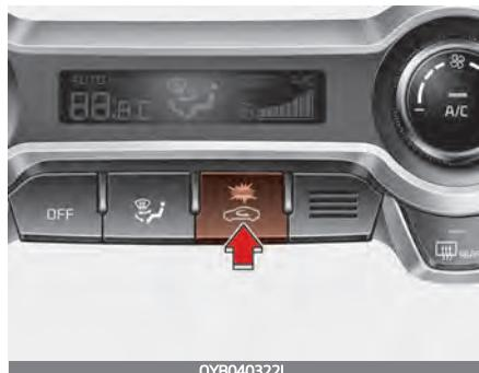
С помощью этого регулятора можно выбрать забор наружного (свежего) воздуха или режим рециркуляции.
