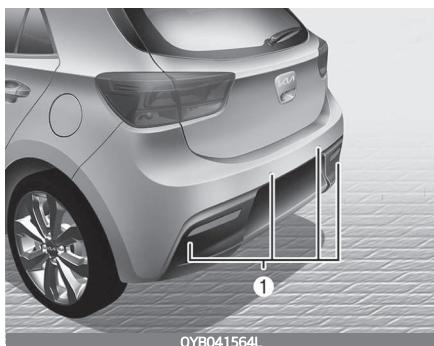
Система предупреждения о расстоянии при парковке задним ходом с помощью звукового сигнала сообщает водителю об обнаружении любого предмета на расстоянии 120 см (48 дюймов) позади автомобиля во время движения назад.
