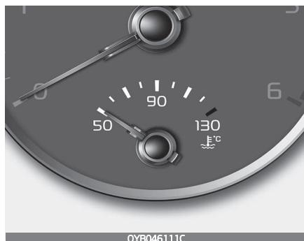
Этот индикатор показывает температуру охлаждающей жидкости двигателя, когда замок зажигания или кнопка «ENGINE START / STOP» (Запуска/остановки двигателя) находятся в положении «ON» (Вкл.).
