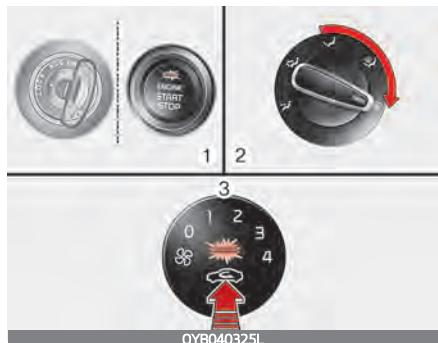
1. Переключите замок зажигания в положение «ON» (Вкл.).
