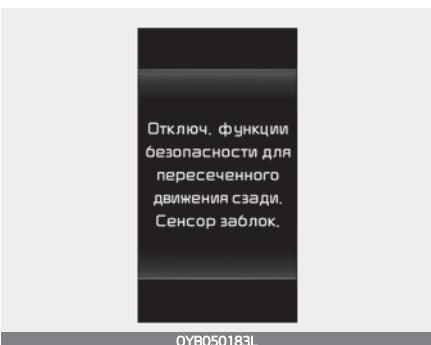
Если поверхность заднего бампера рядом с задним боковым радаром или датчиком покрыта каким-либо веществом, например слоем снега или льда, или на автомобиле установлен прицеп, возможно ухудшение качества обнаружения объектов, а также временное ограничение функциональности или отключение системы безопасности при пересечении перекрестков.
