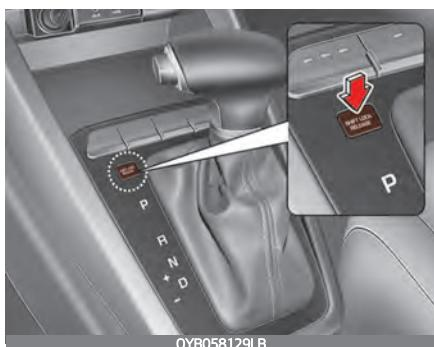
Если рычаг переключения передач невозможно переместить из положения «P» (парковка) или «N» (нейтраль) в положение «R» (задний ход) при нажатой педали тормоза, продолжайте нажимать на тормоз, а затем выполните следующие действия.
