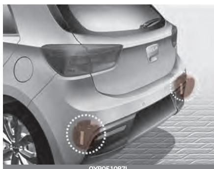
Задние угловые радары — это датчики внутри заднего бампера, предназначенные для обнаружения объектов, находящихся сбоку/сзади автомобиля.
