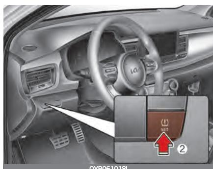
Сигнал низкого давления в шинах (1) / Кнопка настройки системы TPMS (2)
