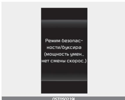
Если приведенное выше предупреждающее сообщение появляется в процессе буксировки прицепа, для предотвращения перегрева двигателя/трансмиссии мощность может быть ограничена или ручная трансмиссия может не работать.
