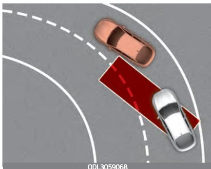
Функция предупреждения об опасности столкновения в слепой зоне (BCW) и вспомогательная функция предотвращения столкновения в слепой зоне (BCA) могут работать неправильно при движении по извилистым дорогам. В определенных ситуациях функция может распознавать автомобиль, движущийся в той же полосе, что и ваш автомобиль.
