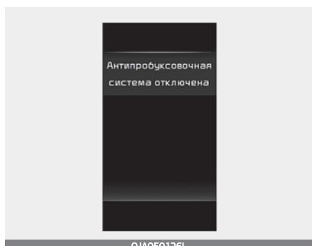
Кратковременно нажмите кнопку «ESC OFF» (Выкл. ESC) (загорится индикатор «ESC OFF» (Выкл. ESC) и отобразится сообщение). В этом состоянии функция управления двигателем не работает. Другими словами, функция регулирования тягового усилия отключается, работает только функция управления тормозами.
