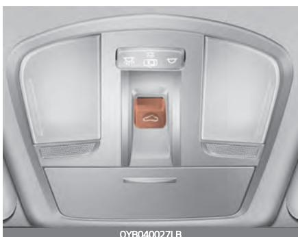
Люком можно управлять только тогда, когда переключатель зажигания или кнопка «ENGINE START/STOP» (Запуск/Остановка двигателя) находится в положении «ON» (Вкл.) или «START» (Запуск).
