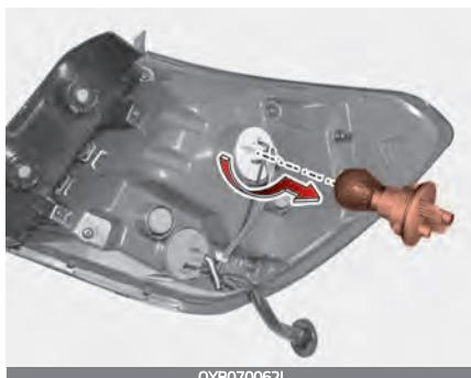
8. Установите патрон на место, совместив выступы на патроне с прорезями на узле. Вставьте патрон в узел, после чего поверните патрон по часовой стрелке.
