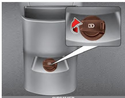
Зарядное устройство USB предназначено для подзарядки аккумуляторов малогабаритных электрических устройств с помощью USB-кабеля. Зарядка возможна, когда кнопка «ENGINE START/STOP» (Запуск/остановка двигателя) находится в положении «ACC/ON/START» (Доп. устройства/Вкл./Пуск).
