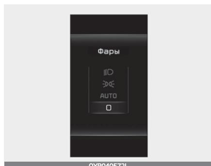
Данный индикатор показывает, какой из приборов наружного освещения был выбран с помощью переключателей управления освещением.
