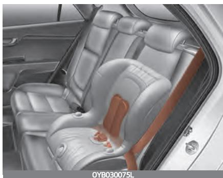
2. Закрепите защелку поясного/плечевого ремня в пряжке. Должен раздаться отчетливый щелчок. Расположите кнопку фиксатора таким образом, чтобы обеспечить к ней беспрепятственный доступ в случае чрезвычайной ситуации.
