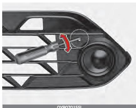
Чтобы увеличить или уменьшить угол наклона передней противотуманной фары, поверните отвертку по часовой или против часовой стрелки.
