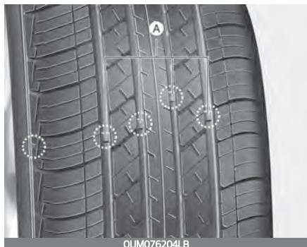
При равномерном износе шины становится виден индикатор износа (A), имеющий вид сплошной полосы. Это значит, что оставшаяся толщина протектора нашине составляет менее 1,6 мм (1/16 дюйма). В этом случае замените шину.
