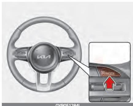
1. Для включения системы нажмите кнопку помощи при вождении. На приборной панели загорится индикатор «CRUISE» (круиз-контроль).
