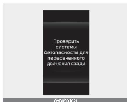
Если система обеспечения безопасности при движении задним ходом работает некорректно, на приборной панели появляется предупреждающее сообщение «Check Rear Cross-Traffic Safety system» (Проверить функцию обеспечения безопасности при движении задним ходом), а функция автоматически выключается или ее работа ограничена. Рекомендуется проверить автомобиль у официального дилера Kia или в партнерской сервисной компании.
