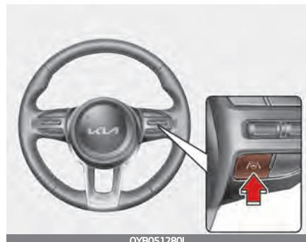
Чтобы включить систему контроля полосы движения, переключите кнопку «ENGINE START/STOP» (Запуск/остановка двигателя) в положение «ON» (Вкл.) и нажмите расположенную на рулевом колесе кнопку системы слежения за полосой движения. На приборной панели включится белый или зеленый индикатор (⌚).
