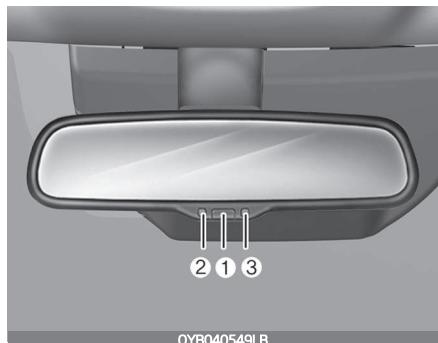
Электрическое зеркало заднего вида автоматически убирает ослепляющий свет фар позади идущих транспортных средств в ночные времена или в условиях низкой освещенности. Датчик (3), установленный в зеркале, определяет уровень освещенности вокруг автомобиля и автоматически убирает ослепляющий свет фар позади идущих автомобилей.
