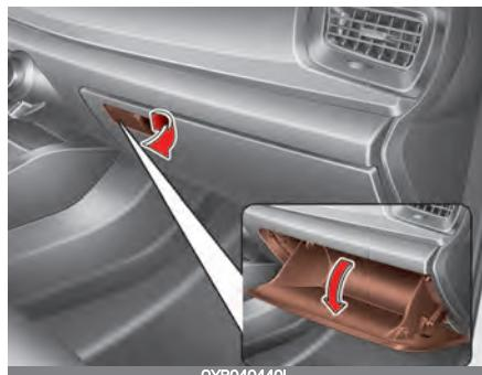
Чтобы открыть перчаточный ящик, потянните за ручку, после чего перчаточный ящик откроется автоматически. Закройте перчаточный ящик после использования.
