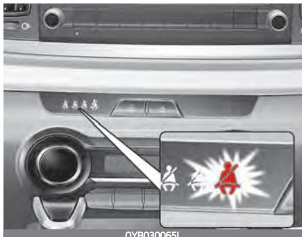
В качестве напоминания для переднего пассажира индикатор ремня безопасности загорится приблизительно на 6 секунд после каждого переключения замка зажигания или кнопки «ENGINE START/STOP» (запуска/остановки двигателя) в положение «ON» (Вкл.), независимо от того, пристегнут ремень или нет.
