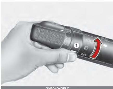
Для включения задних противотуманных фар переведите переключатель задних противотуманных фар (1) в положение «ON» (Вкл.), когда передние фары включены.
