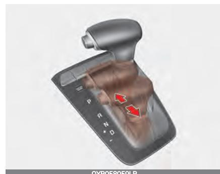
Независимо от того, стоит автомобиль или движется, спортивный режим можно выбрать, переместив рычаг переключения передач из положения «D» (передний ход) в паз ручного управления. Для того чтобы вернуть рычаг в положение «D» (передний ход), переместите его обратно в основной паз.
