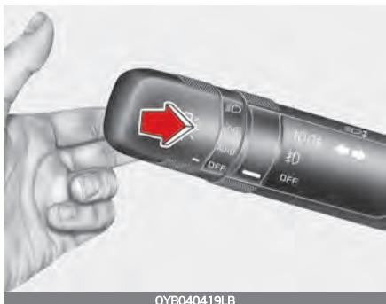
Для мигания дальним светом потянуть рычаг на себя. После отпускания рычаг вернется в исходное положение (ближний свет). Для использования функции мигания включение переключателя фар головного света не требуется.
