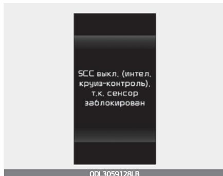
Если крышка переднего радара или датчик покрыты каким-либо веществом, например снегом или дождем, возможно ухудшение качества обнаружения объектов, а также временное ограничение функциональности или отключение системы интеллектуального круиз-контроля.
