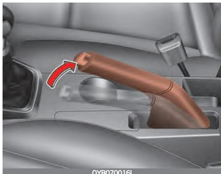
Проверьте ход стояночного тормоза, подсчитав количество слышимых «щелчков», полностью отпустив его из отжатого положения. Также стояночный тормоз должен самостоятельно обеспечивать удержание автомобиля на достаточно крутом уклоне. Если ход больше или меньше указанного, следует проверить систему в специализированной мастерской. Kia рекомендует обратиться к официальному дилеру Kia или партнерской сервисной компании.
