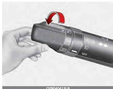
Когда переключатель освещения находится в положении работы передних фар (третья позиция), то горят передние фары, задние габаритные огни, фонарь освещения номерного знака и лампа подсветки приборной панели.
