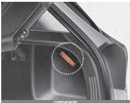
Лампа подсветки багажного отделения загорается при открывании двери багажного отделения.
