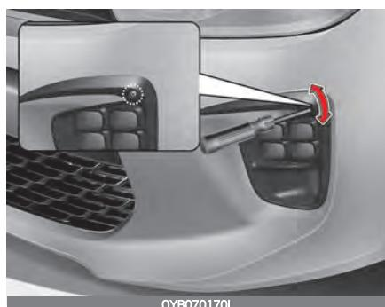
Для передних противотуманных фар регулировку угла наклона можно выполнить так же, как для фар головного света. Регулируйте угол наклона передних противотуманных фар, когда сами фары и аккумуляторная батарея находятся в нормальном состоянии.
