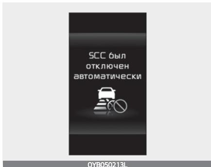
Система интеллектуального круиз-контроля временно автоматически отключается в перечисленных ниже ситуациях.
