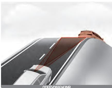
Эффективность системы предотвращения лобового столкновения может снижаться при движении на спусках или подъемах. Система распознавания камеры фронтального обзора или датчика переднего радара может не обнаружить движущийся впереди автомобиль, пешехода или велосипедиста.
