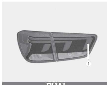
Если задняя противотуманная фара (светодиодная) (1) не работает, следует проверить автомобиль в специализированной мастерской.
