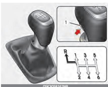
➡ Рычаг переключения передач можно перемещать без нажатия кнопки (1).
