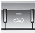
Когда выбрано положение забора наружного (свежего) воздуха, воздух поступает снаружи и нагревается или охлаждается в зависимости от выбранной функции.
