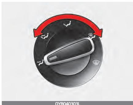
Ручка выбора режима управляет направлением потока воздуха через вентиляционную систему.
