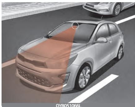
Камера переднего — это датчик, определяющий полосу движения. Если обзор камеры переднего вида закрыт сильным дождем, снегом, туманом или посторонними веществами, функция может быть временно отключена и не будет работать надлежащим образом до устранения факторов, ухудшающих характеристики обнаружения датчика. Всегда поддерживайте чистоту датчика.
