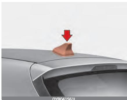
Антенна в виде акульего плавника на крыше передает и принимает беспроводные сигналы, например AM/FM, DAB, GNSS и т. д.
