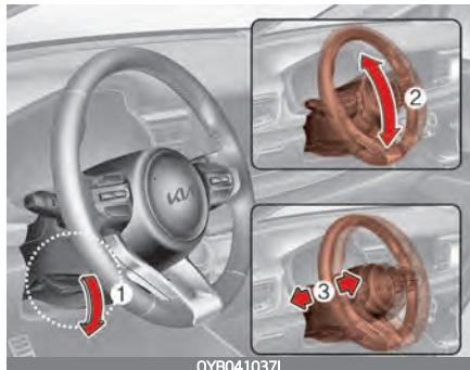
Для изменения угла наклона рулевого колеса потяните вниз рычажок фиксатора (1), установите рулевое колесо под нужным углом (2) и на нужной высоте (3, при наличии), затем потяните рычажок фиксатора вверх, чтобы зафиксировать рулевое колесо в необходимом положении. Выполните регулировку положения рулевого колеса перед началом движения.
