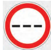
Этот символ отображается на приборной панели и на дисплее системы навигации, когда интеллектуальная функция предупреждения об ограничении скорости не обладает достоверной информацией об ограничениях скорости.
