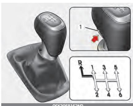
⇒ Рычаг переключения передач можно перемещать без нажатия кнопки (1).
