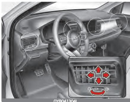
Дефлекторы можно открыть или закрыть по отдельности с помощью горизонтального дискового переключателя. Чтобы закрыть вентиляционное отверстие, поверните его вниз до упора. Чтобы открыть вентиляционное отверстие, поверните его вверх в необходимое положение.
