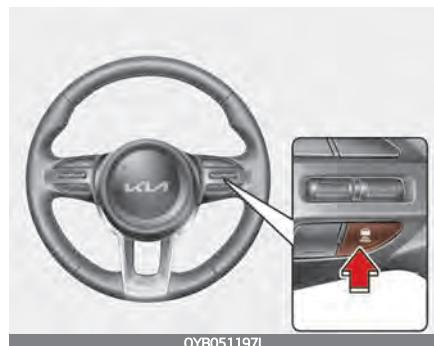
С каждым нажатием кнопки дистанция до движущегося впереди автомобиля изменяется следующим образом:
