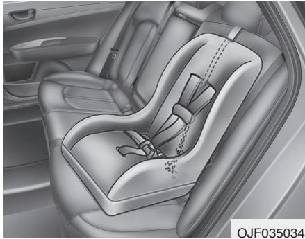
1. Pārvelciet bērnu sēdeklīša saiti pār atzveltni. Izvietojot augšējo saiti, ievērojiet CRS izgatavotāja norādījumus.
