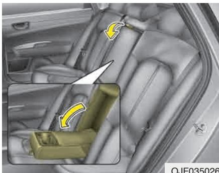
Lai izmantotu elkoņu balstu, izvelciet to no atzveltnes.
