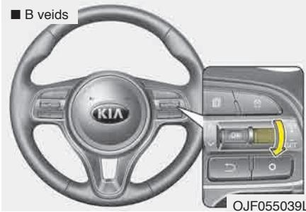
3. Pārvietojiet sviru uz leju (pret SET-), un atlaidiet, ka sasniegts vajadzīgais ātrums. Indikators CRUISE izgaismosies. Tajā pašā laikā atlaidiet akseleratora pedāli. Izvēlētais ātrums tiks uzturēts automātiski.
