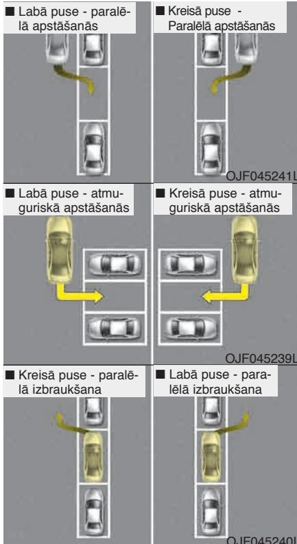
Sistēma palīdzēs novietot automobili vidū, vai aiz stāvoša automobiļa. Izmantojiet sistēmu, ja ir atbilstība visiem šiem nosacījumiem.
