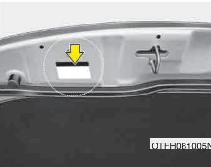
Dzesēšanas līdzekļa uzlīme atrodas zem motorpārsega.
