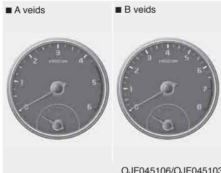
Tahometrs rāda aptuveno motora apgriezienu skaitu minūtē (apgr./min.).
